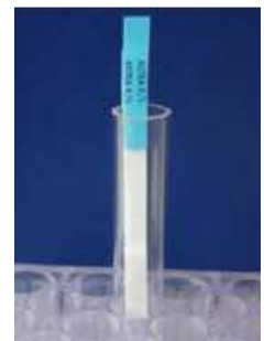
WŁOŻYĆ PASEK DO PRÓBKWI Z PRÓBKĄ
