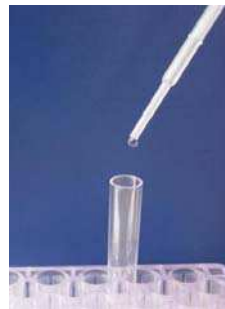
ODPIPETOWAĆ 100µl MOCZU I 100µl ROZCIENICZALNIKA PRÓBEK
